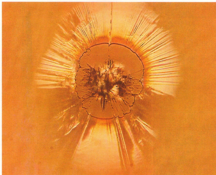
附图3 样品在峰值功率密度为 1.393 \text{ GW/cm}^2 时的 5X 显微图
